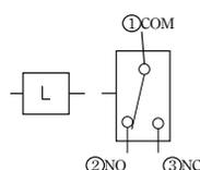
單刀雙頭微動開關工作狀態，流量上升至上切換值時接線端子 (1)COM-(3)NC 接通；流量下降至下切換值時，(1)COM-(2)NO 接通。
